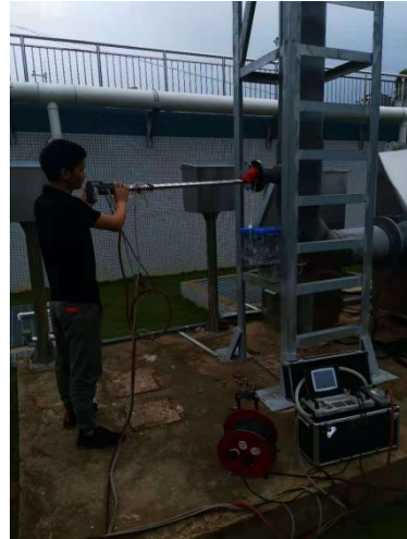
废气处理后采样
